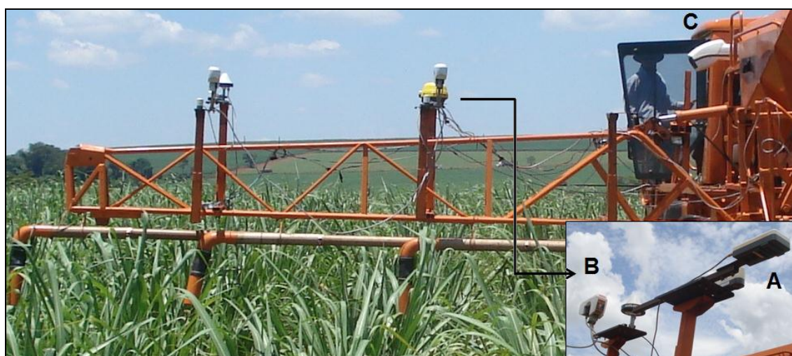
Figura 5 – Disposição dos sensores Crop Circle (A), GreenSeeker (B) e N-Sensor (C) instalados na barra de aplicação (A e B) e entre a cabine e a caixa de fertilizantes do veículo (C). Detalhe mostra a disposição dos sensores na barra medindo a mesma linha.
