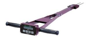
Figura 1. Vista do sensor TDR utilizado no estudo
