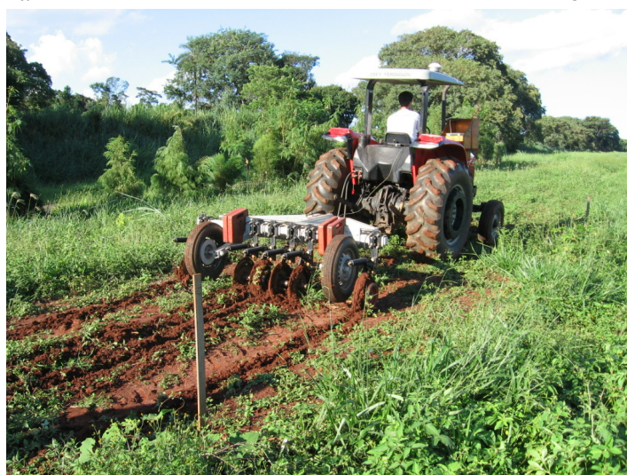
Figura 2.1 - Esquema de funcionamento do equipamento Veris ® 3100 para mensuração da condutividade elétrica, configurado no estudo para realizar leituras em duas camadas, de 0m a 0,30m e de 0m a 0,90m (a); foto do coletor de dados do aparelho (b); foto do aparelho coletando informações numa das áreas estabelecidas para o estudo (c).
