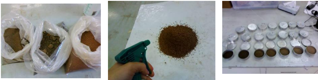
Figura 7: Os solos utilizados no estudo (esquerda); solo sendo umidecido (centro); as amostras obtidas (direita).
