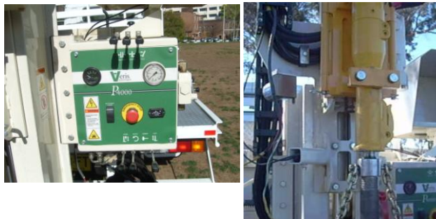
Figura 5: À esquerda os controles hidráulicos e à direita o martelo hidráulico.
