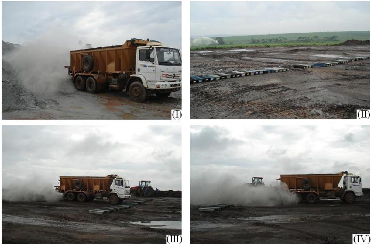
Figura 7: (I) Caminhão distribuidor efetuando a aferição da vazão; (II) bandejas pareadas para início do teste; (III) e (IV) caminhão aplicando calcário na faixa das bandejas de coleta.
