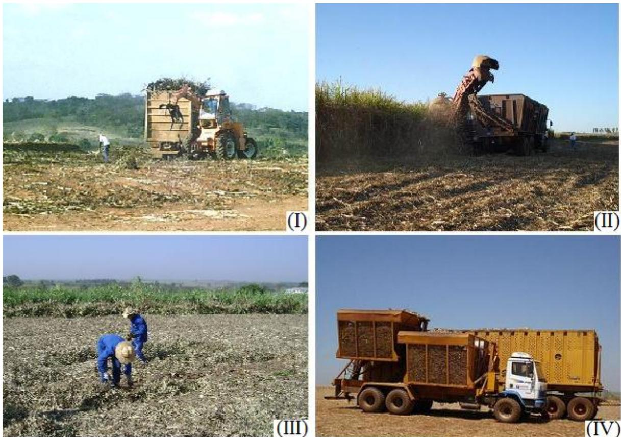
Figura 5: (I) recolhimento da cana queimada cortada manualmente; (II) corte mecanizado da cana crua; (III) avaliação de perda da colheita mecanizada; (IV) caminhão transbordo depositando a cana colhida mecanicamente na carreta de transporte.
