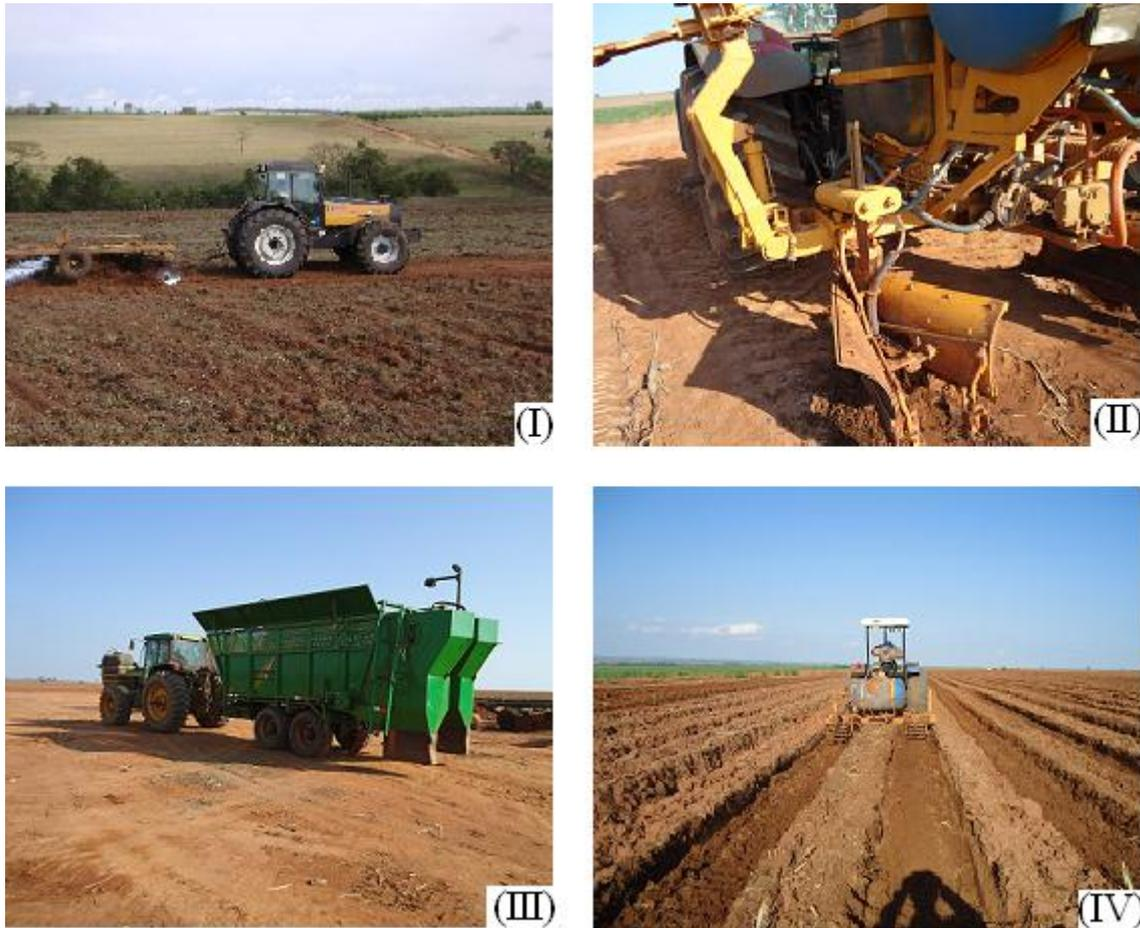
Figura 1: (I) Trator Valtra BH 180 gradeando área de expansão; (II) haste sulcadora com aplicação de adubo no momento da sulcação; (III) distribuidora de mudas Antoniosi nas linhas de 1,50 m; (IV) operação de cobertura das mudas de cana.
