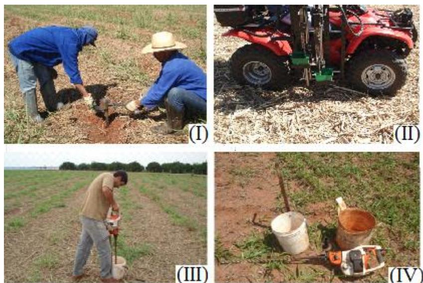
Figura 6: (I) Coleta de solo com o método A, utilização de sonda e dois funcionários para o serviço, em área de terceiro corte; (II) quadriciclo e amostrador automático utilizado pelo método B, em área de terceiro corte; (III) amostragem feita pelo método C, utilização de um funcionário com um perfurador mecânico com broca tipo trado; (IV) Equipamento utilizado pelo método C.
