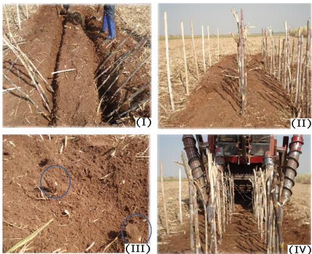
Figura 22: Simulação de colheita do sorgo sacarino para observar se ocorre corte negativo na base do sorgo, com o deslocamento lateral da colhedora; (I) abertura das duas valas de 0,30 m para simulação das linhas de sorgo sacarino; (II) linhas de cana simulando as plantas de sorgo sacarino; (III) evidências de não ocorrência de corte negativo na base da planta de sorgo sacarino (IV) simulação da colheita de sorgo com a colhedora de 1 linha Case 7700.
