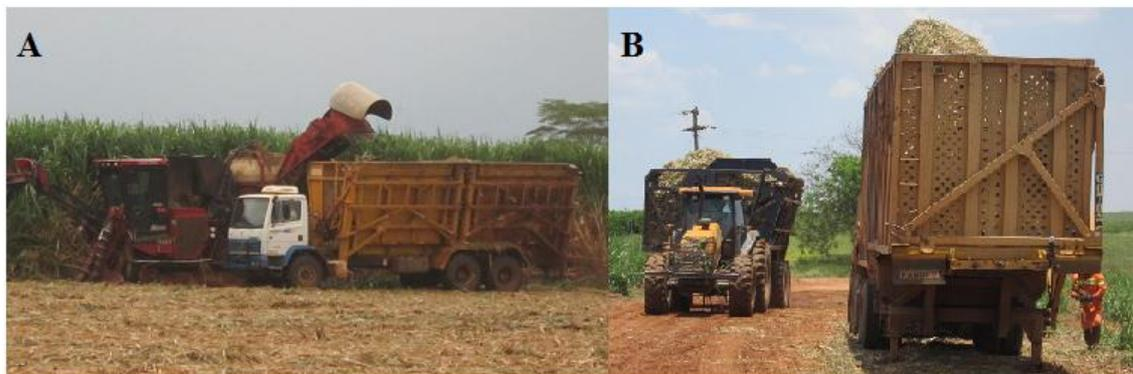
Figura 4. Sistema de transbordo caminhão-transbordo (A) e sistema de trator rebocando transbordo (B).
