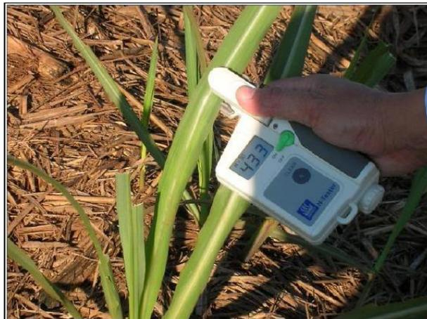
**Figura 6** - N-Tester/Yara (Clorofilômetro).
