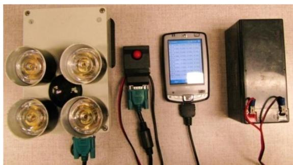
Figura 1: Sensor multiespectral conectado a um palmtop e bateria.
