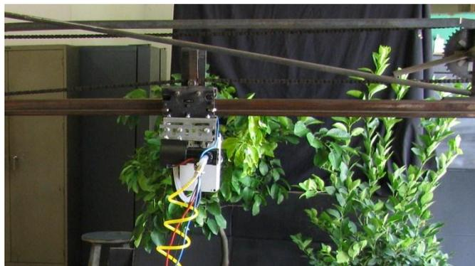
Figura 6: Sensor instalado no trilho realizando leituras em árvores de citros.
