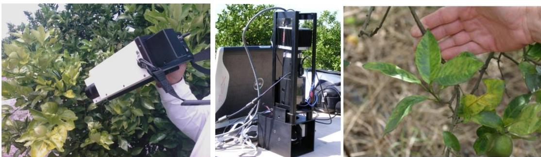
Figura 16: Espectrômetro portátil (esquerda); câmera hiperespectral (centro); sintomas do HLB (direita).
