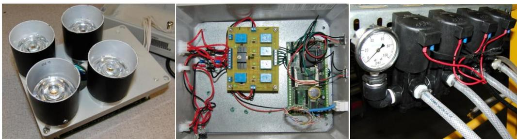
Figura 3: Sensor multiespectral (esquerda); unidade de controle (centro); válvulas solenóides (direita).
