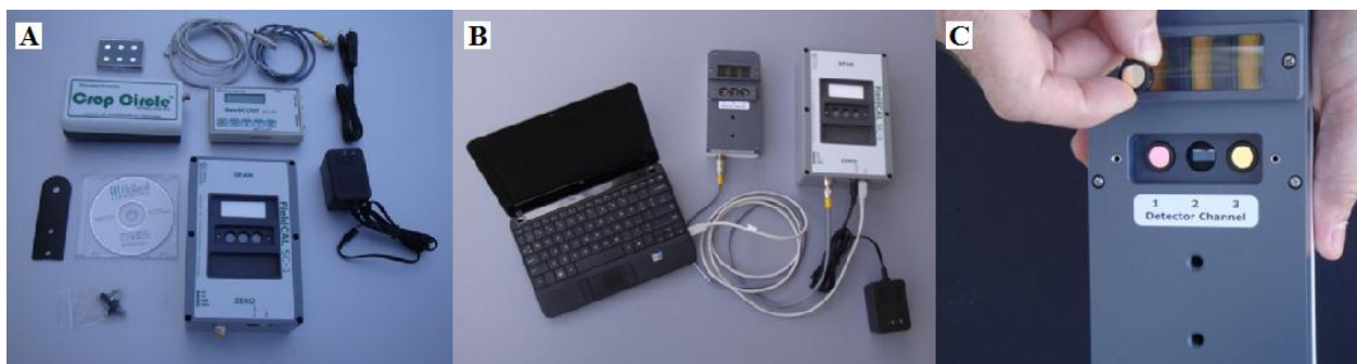
Fig. 1. Componentes do sensor (A), sensor acoplado a computador para calibração (B) e troca de filtros óticos (C)
