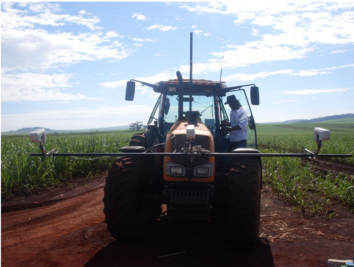
Figura 3. Conjunto de sensores óticos ativos GreenSeeker® RT200 montados em um suporte na dianteira do trator
