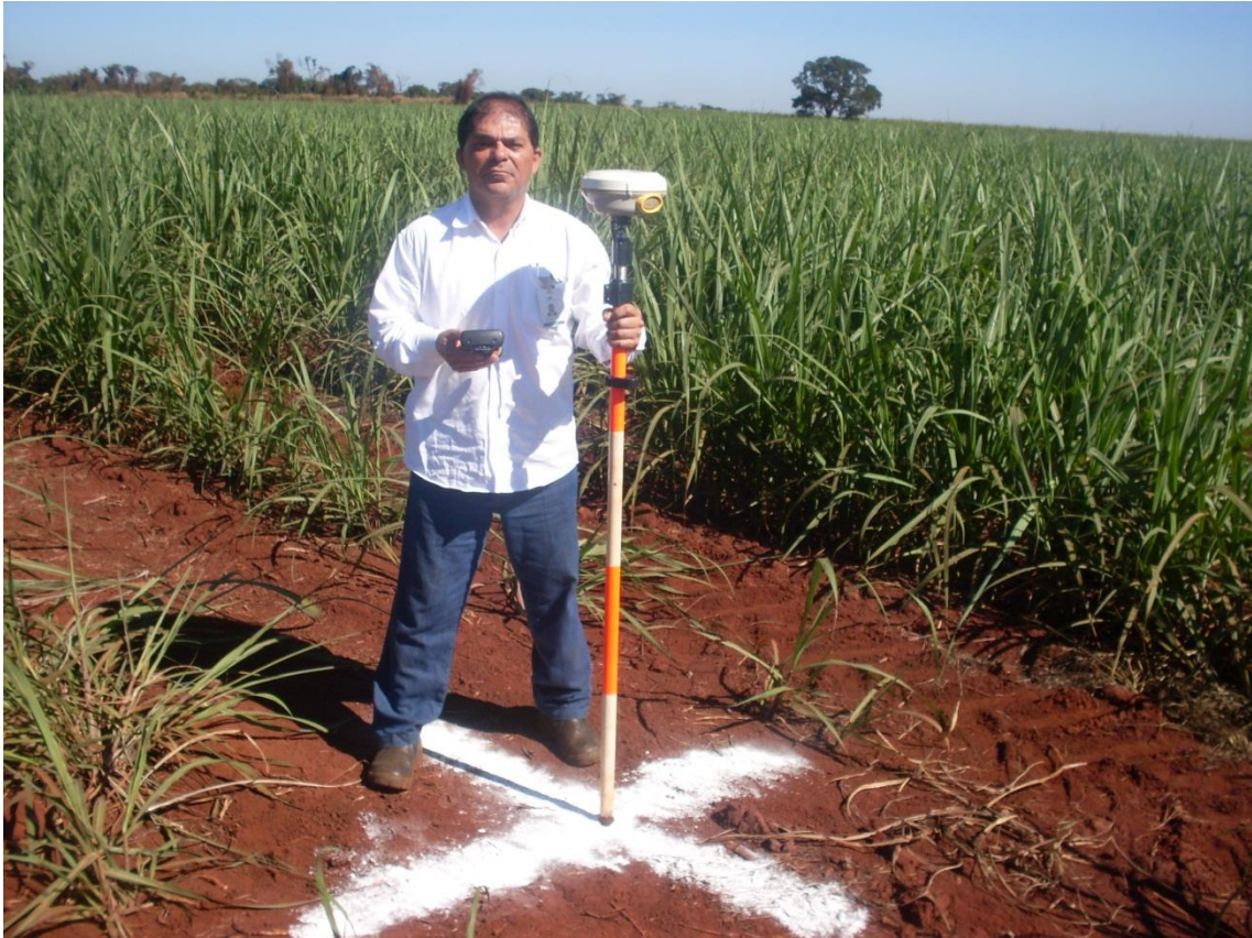
Figura 6. Demarcação dos pontos de apoio utilizados para ajuste do georreferenciamento do ortomosaico.
