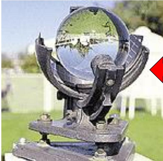
Heliógrafo – equipamento utilizado para a obtenção do número de horas efetivas de brilho solar (radiação solar direta)
